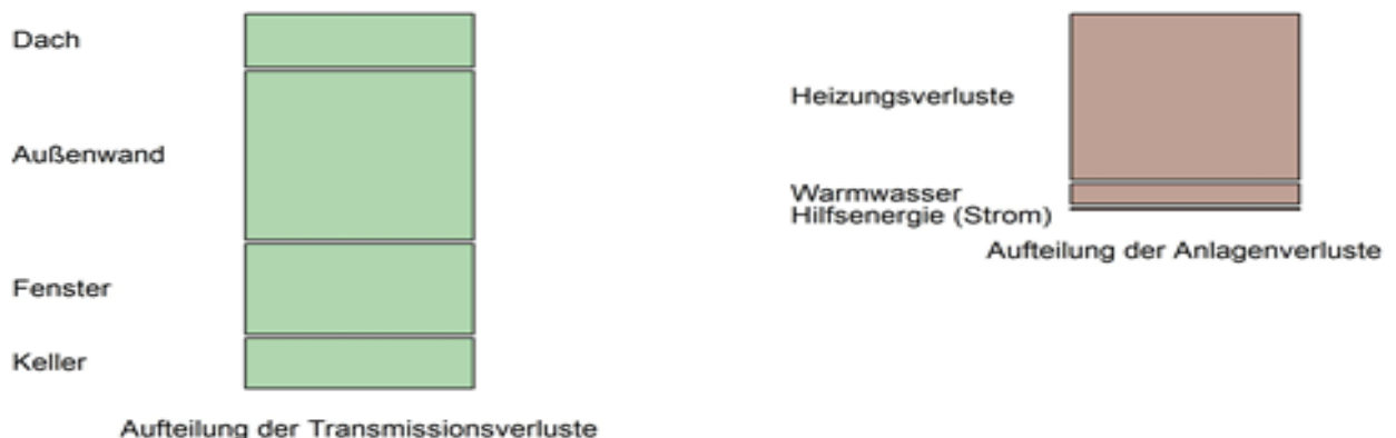
Abbildung 51: Ergebnisse der Verluste über Bauteile und Anlagentechnik (Friedhof Wellesweiler)
