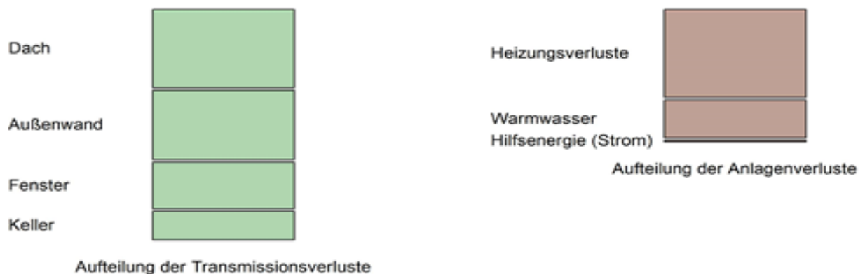
Abbildung 77: Ergebnisse der Verluste über Bauteile und Anlagentechnik (Wibilohaus)
