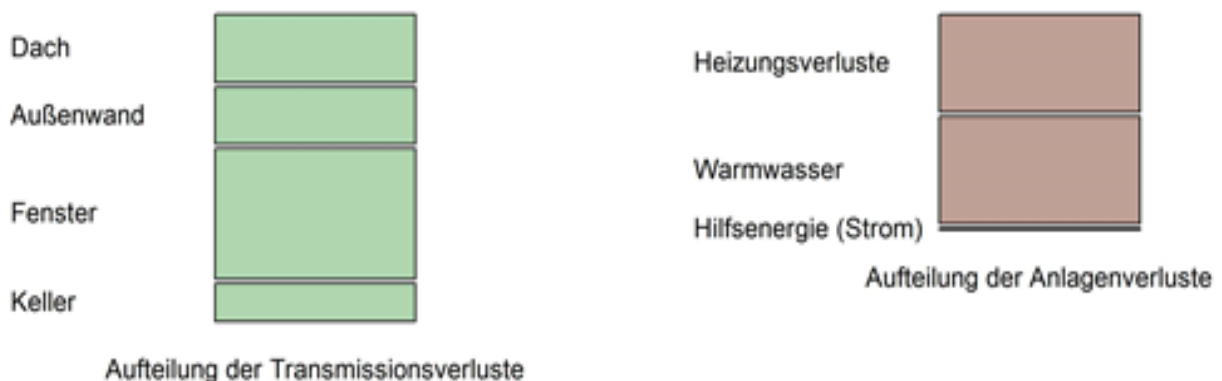
Abbildung 31: Ergebnisse der Verluste über Bauteile und Anlagentechnik (Ohlenbachhalle)
