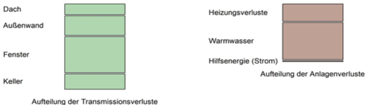
Abbildung 75: Ergebnisse der Verluste über Bauteile und Anlagentechnik (Kulturhaus)
