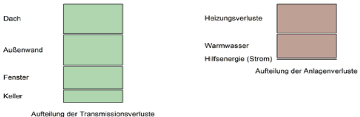
Abbildung 83: Ergebnisse der Verluste über Bauteile und Anlagentechnik (Grundschule Stadtpark)
