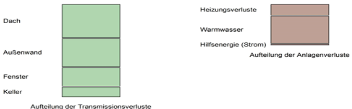
Abbildung 23: Ergebnisse der Verluste über Bauteile und Anlagentechnik (Kindergarten Goethestraße)
