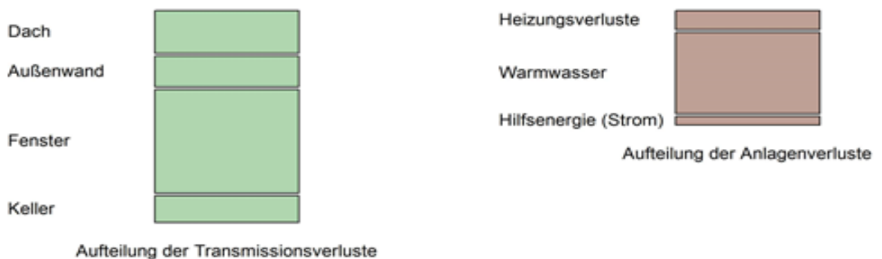
Abbildung 33: Ergebnisse der Verluste über Bauteile und Anlagentechnik (Sporthalle Wellesweiler)
