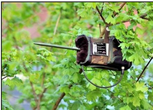
**Abb. 5:** Batcorder: bestehend aus Empfangseinheit (rechts) und schmales Hochfrequenzmikrofon (Beispieldarstellung). Die Batcorder wurden während der mobilen Runden ausgebracht, nach Abschluss der Begehung eingesammelt, die Daten im Büro am Rechner analysiert.
